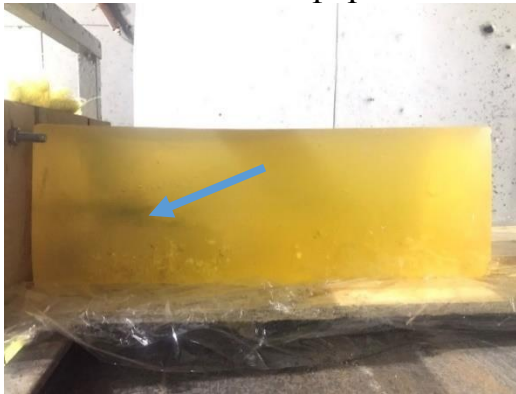
Рис. 2.2. Желатиновий блок з одним рановим каналом
